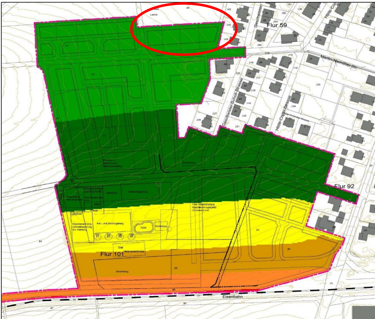
Abb. 4: Geräuschbelastung im Nachtzeitraum durch den Schienenverkehr (unmaßstäblich) (TÜV Hessen, 2019)
